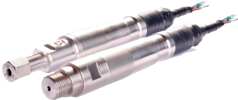
Die Aufnehmerserie PF-3 bezeichnet Sensoren zur Messung von Flüssigkeitsdrücken. Sie lassen sich über das stirnseitige Gewinde an eine Armatur anschließen und stellen so Kontakt zwischen der Sensormembran und dem zu messenden Fluidruck her. Die Standardversionen bieten wahlweise ein 1/2"- oder ein Ermeto-6S-Gewinde. Auf Wunsch können auch Sonderanpassungen und andere Gewinde ausgeführt werden.
