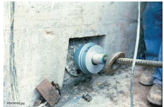
Fig.: Célula de carga, situada sobre la placa de reparto, antes de tesar el anclaje
