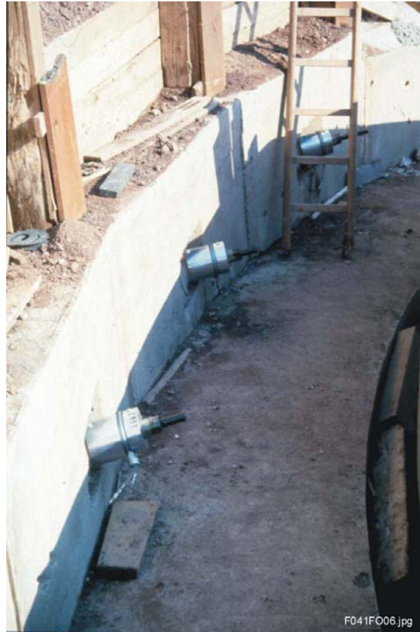
Fig.: Célula de carga para anclajes montada
