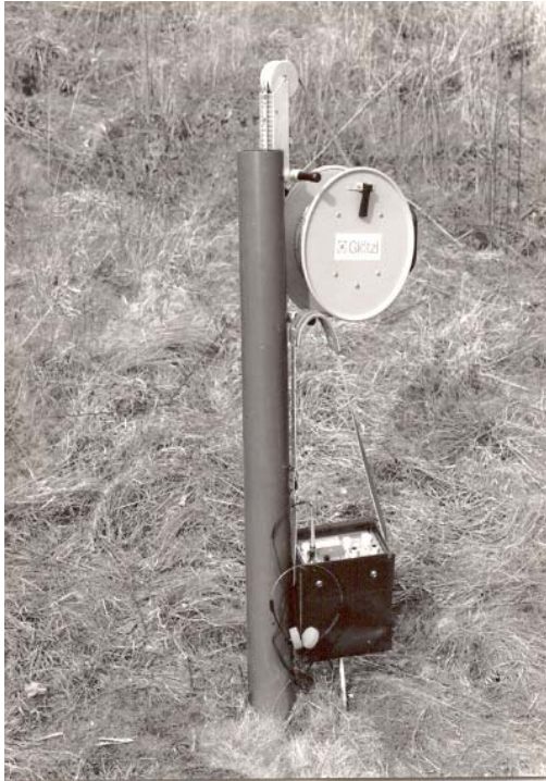
Fig.: Equipo de medición con tubería guía
