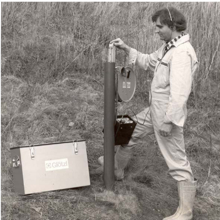
Fig.: Lectura con la sonda de asientos para placas de metal
