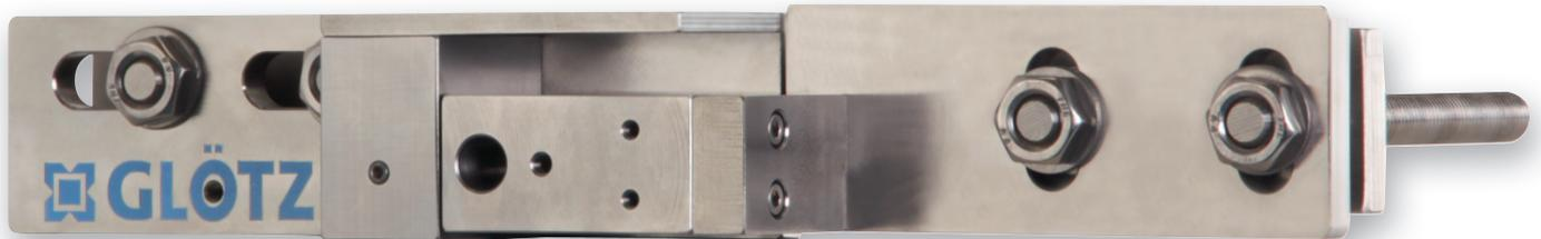
Das dreidimensionale Fissurometer dient der Erfassung der räumlichen Verschiebung von zwei Bauwerksteilen gegeneinander. Die Messkonsole und der Anschlagwinkel des Messgerätes werden fixiert, mittels Bolzen auf rauem Bruchstein einzementiert oder durch Halteplatten auf glatte Oberflächen mit Dübelbefestigungen aufgeschraubt. Die Verschiebungen werden mit einer Messuhr manuell oder mit Wegaufnehmern und Messcontrollern für eine Ketteninstrumentierung elektrisch in X-, Y- und Z-Richtung erfasst.
