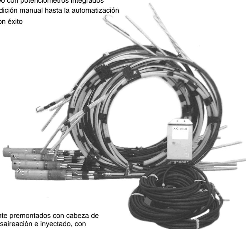
**Figura: 4** Extensómetros completamente premontados con cabeza de introducción en sondeo, tuberías de desaireación e inyectado, con packer metálico para fijar y hermetizar las cabezas. Armario de centralización y conmutación con cable y potenciómetros en las cabezas.
