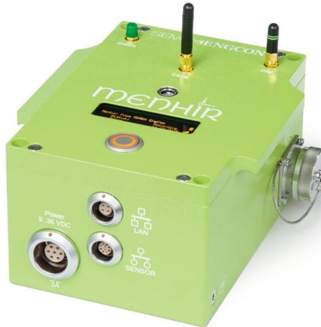
MENHIR (Modular Enhanced Intelligent Recorder) mide vibraciones de una manera eficiente y segura. En el campo de la dinámica de construcción, monitoreo de sistemas de construcciones y sísmico, se pueden resolver fácilmente las tareas más complejas con el MENHIR. Gracias al concepto operativo simple e intuitivo, cualquier persona puede usar MENHIR con éxito y ahorrando tiempo con necesidades mínimas de capacitación.
